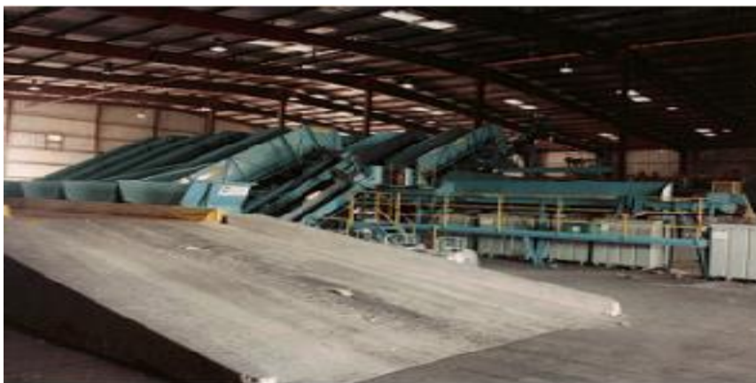
Εικόνα 14 Χώρος ζύγισης και χοάνες υποδοχής μιας μονάδας ανάκτησης υλικών
